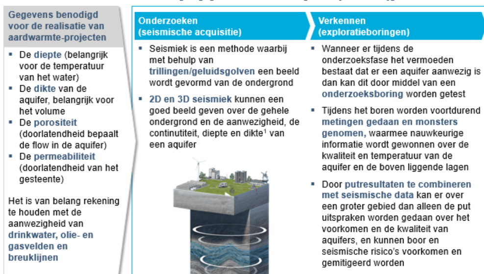
Figuur 12: Via seismische acquisitie en exploratieboringen wordt de nodige kennis van de gehele ondergrond steeds nauwkeuriger bepaald
