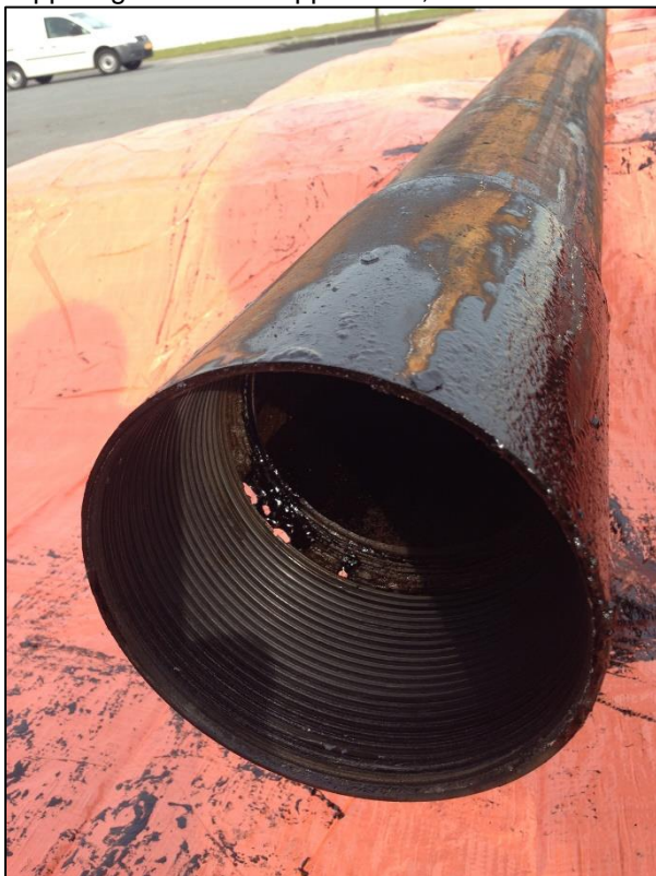
Figuur schade BTC koppeling, zie erosie bij overgang schroefdraad/verbuizing.
