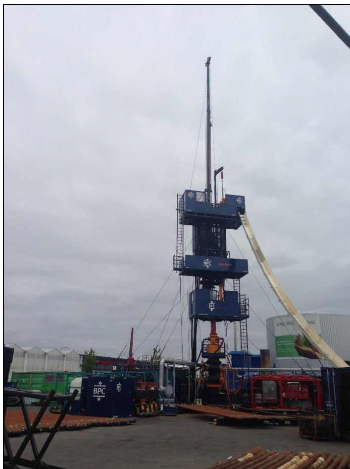
Figuur; work-over-rig voor het boren van de side track.
